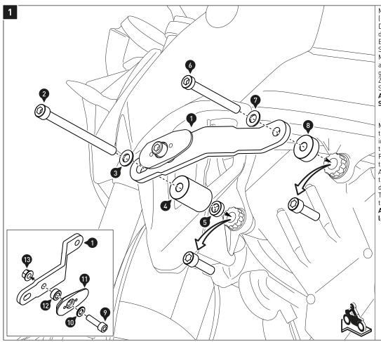
Montieren Sie die Verschraubplatte (11) am Anbaublech (1) wie in der Detailzeichnung gezeigt. Ziehen Sie die Schraube (9) noch nicht an. Entfernen Sie die originalen Schrauben von den Anbaupunkten. Montieren Sie das Anbaublech (1) am Fahrzeug, wie in der Zeichnung gezeigt.
