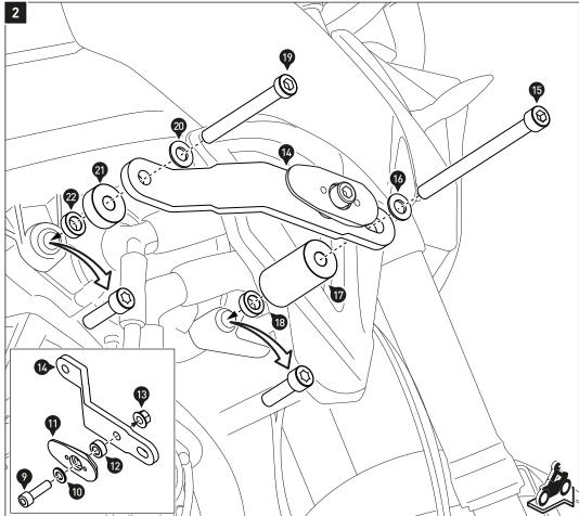
Montieren Sie die Adapterplatte (11) am Anbaublech (14) wie in der Detailzeichnung gezeigt. Ziehen Sie die Schraube (9) noch nicht an. Entfernen Sie die originalen Schrauben von den Anbaupunkten. Montieren Sie das Anbaublech (14) am Fahrzeug, wie in der Zeichnung
